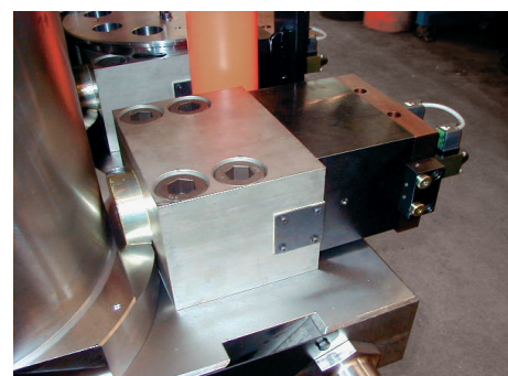
Elementos de sujeción en forma de cuña en una prensa de forja
