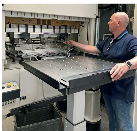
Application d'un chariot pour changement d'outils RW500 avec plateau à billes à une presse à estamper Bruderer
