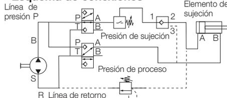
La presión hidráulica debe permanecer asegurada por motivos de seguridad en el sentido de las directivas de maquinaria ML 2006/42/CE. Los troqueles o moldes superiores que estén sujetos mediante elementos de sujeción en forma de arco, se deben asegurar mecánicamente durante los trabajos de mantenimiento.
