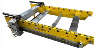
8.18354 accionamiento manual con manivela y multiplicador peso del troquel hasta 6 t
