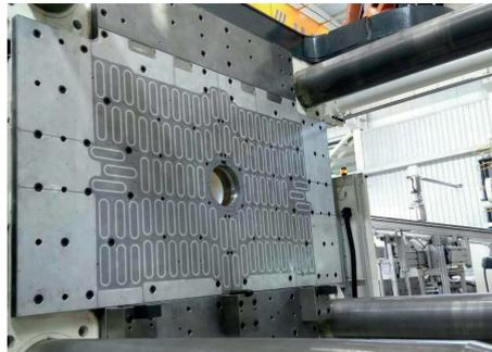
R-MAG-P, con polos rectangulares para máquinas de moldeo por inyección
