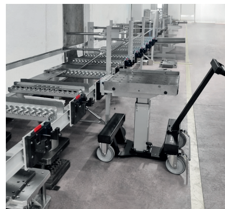
Sistema de estanterías con ganchos de acoplamiento y carro para el cambio de troqueles y moldes RW 500
