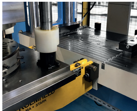
Listwy mocujące zamontowane na stole prasy i suwaku. Łatwa wymiana narzędzi za pomocą konsol transportowych oraz hydraulicznych listw kulkowych zamontowanych w rowkach typu T stołu prasy.
