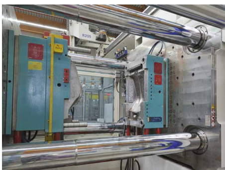
R-MAG-P, con polos cuadrados para máquinas de moldeo por inyección hasta 300 t
