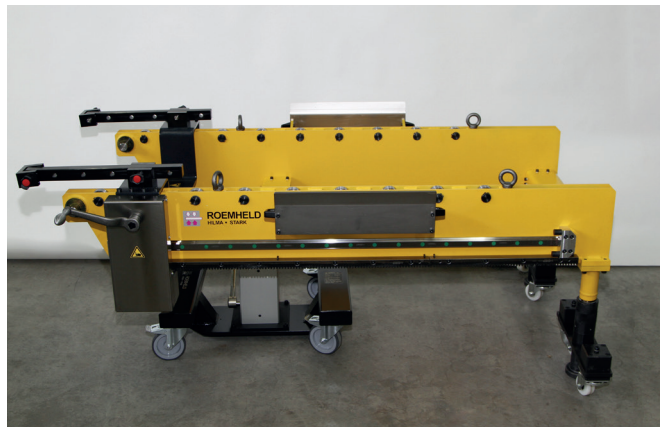
Console pour le changement d'outils avec manivelle et engrenage de transmission
