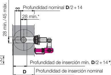
\*) Si la profundidad de la ranura de sujeción < profundidad nominal, puede que deba adaptarse el ajuste de la consulta S2 «Posición de troquel». Si fuera preciso, también puede alargarse el perno de accionamiento (M6).
