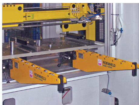
Consolas portadoras desplazables colgadas
