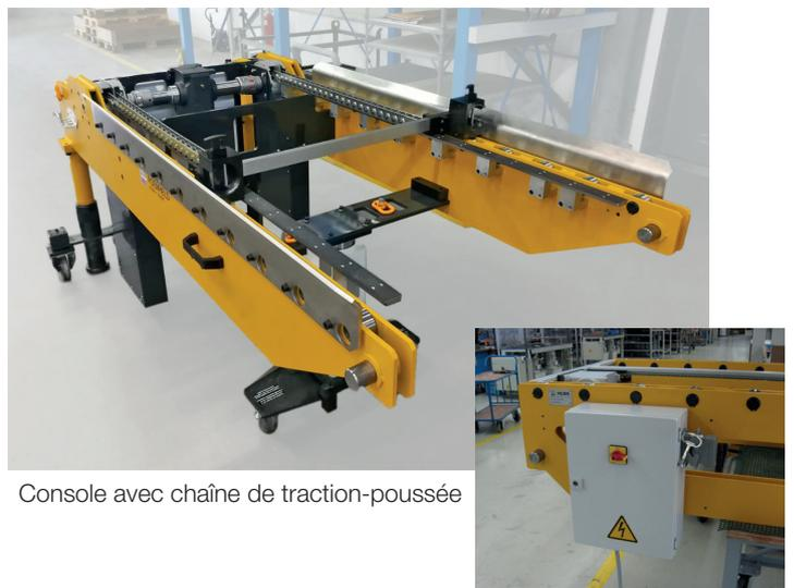
Console avec chaîne de traction-poussée
