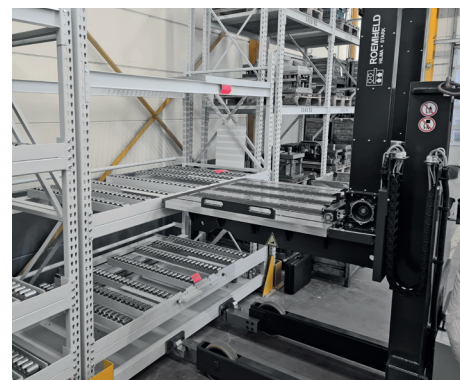
Carro para el cambio de troqueles y moldes RWA 4000 con barra de acoplamiento y cadena de tracción y de empuje
